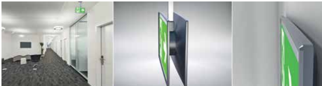
Lichtgestalt: Eine 4 mm dünne Piktogrammscheibe dient der Rettungszeichenleuchte als Lichtquelle. Das Konzept von RP-Technik aus Rodgau hat den German Design Award 2016 erhalten
