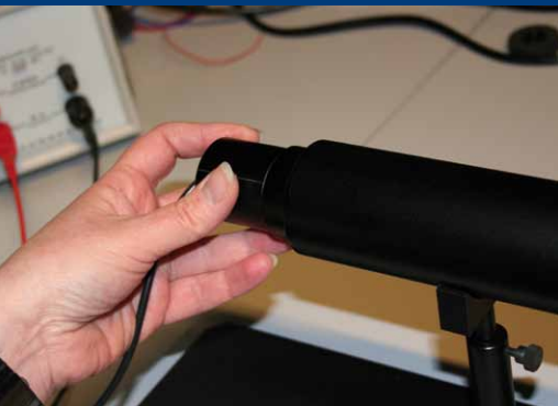
Messung der Licht- stärke einer LED
