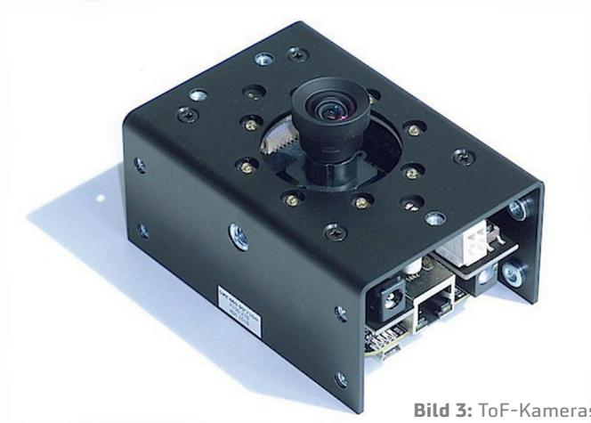
Bild 3: ToF-Kamerasystem DME 660
