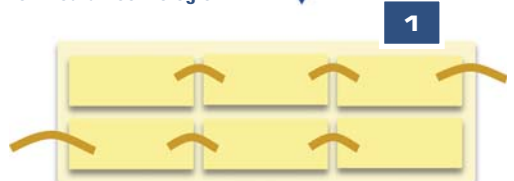
Bild 1. Wire Bonding einzelner Chips in der Chip-on-Board-Technologie
